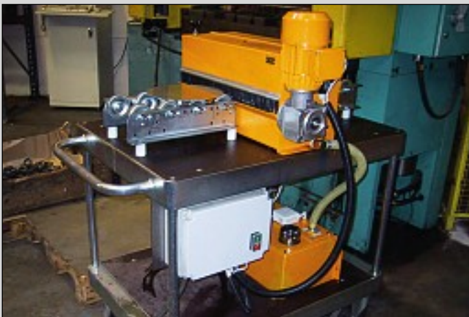
MLM motordriven ämnessmörjare med mobil vagn MLM motorized sheet lubricator with mobile cart MLM motorisierter Tafelbefetter mit fahrbarem Gestell
