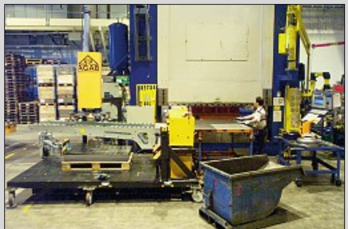
MLM motordriven smörjstation med plockautomat MLM motorized lubrication station with auto destacker MLM motorisierte Beölungsstation mit Entstapelanlage
