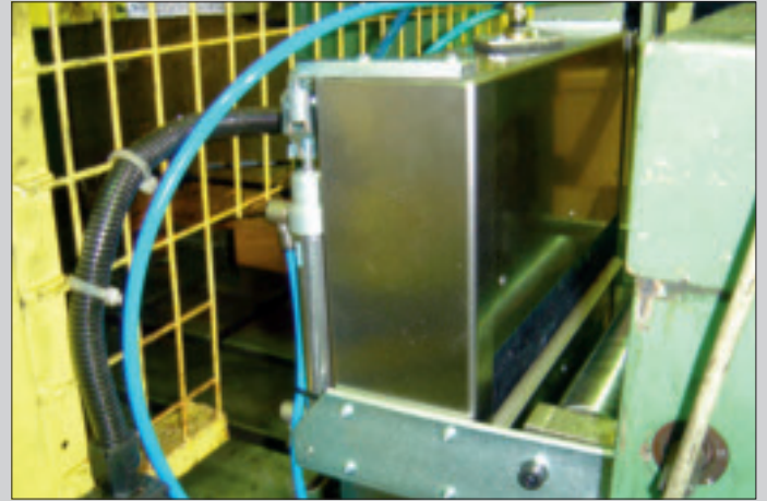
Pneumatiska cylindrar för öppning Pneumatic cylinders for opening Pneumatische Zylinder zum Öffnen
