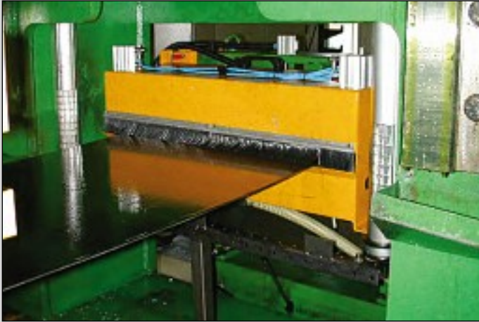
MLC med avstrykarvalsar och tätningsborst MLC with offcoating rollers and sealing brush MLC mit Abstreichwalzen mit Dichtungsbürste
