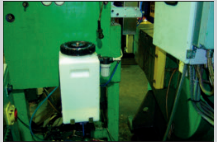
14 liters tank med returfilter 14 liters tank with return filter 14 Liter Ölbehälter mit Rücklauffilter
