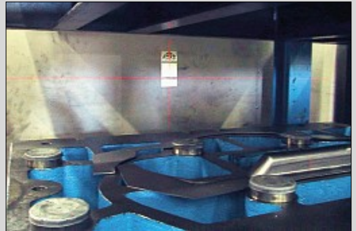
Krysslaser för exakt positionering Cross laser for exactly positioning Kreuzlaser zur genauen Positionierung
