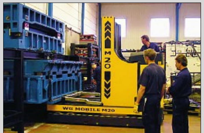
Utdragning av verktyg från ställ Pulling the die out of the rack Werkzeugausschub vom Gestell
