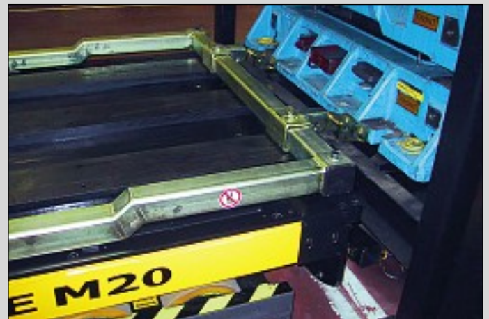
Steglös inställning av automatiska krokar Adjustable automatic hooks Stufenlose automatische Hakenvorrichtung
