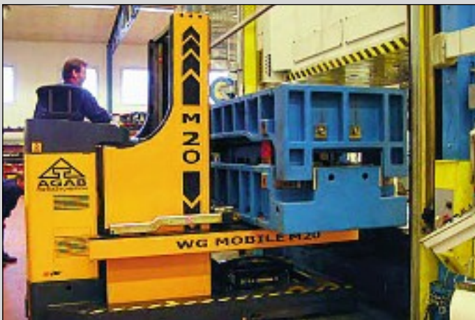
Inskjutning av verktyg i press Pushing the die into the press Werkzeugeinschub in die Presse
