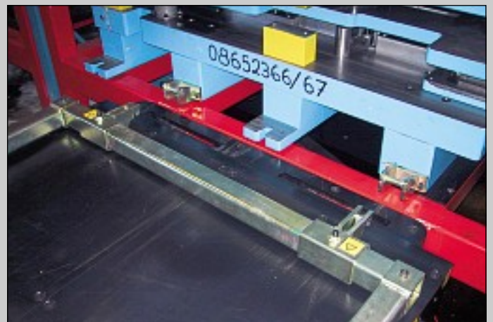
Steglös inställning av automatiska krokar Adjustable automatic hooks Stufenlose automatische Hakeneinstellung
